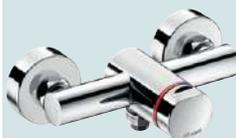
■ Monocommande apparent 3/4", sortie haute ■ Installation murale en applique ■ Réglage de la température et déclenchement sur le croisillon métal ■ Butée de température maximale (réglable par l'installateur) ■ Déclenchement souple ■ Temporisation à ~30 secondes, débit 6 l/min à 3 bar, ajustable ■ Filtres et clapets anti-retour intégrés ■ Raccords excentrés M1/2" pour entraxe de 130 à 170 mm ■ Garantie 10 ans
