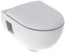
■ Cuvette Rimfree sans bride, à fond creux ■ Type 1, volume total 6 l, selon EN 997 ■ Abattant WC en duroplast ■ Dégagement au sol 7 cm ■ Couvercle d'abattant recouvrant
