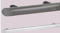
■ 300 mm ■ Finition aluminium époxy anthracite métallisé ■ Utilisation comme barre d'appui, de maintien ou de relèvement ■ Tube aluminium épaisseur 3 mm, pieds en aluminium massif ■ Profil rond Ø 35 avec plat ergonomique anti-rotation pour une préhension optimale ■ Écartement entre la barre et le mur de 38 mm ■ Fixations invisibles, vis inox Ø 8 x 70 mm pour mur béton ■ Testée à plus de 200 kg ■ CE, garantie 10 ans
