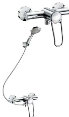
■ Avec équilibrage de pression ■ Sécurité anti-brûlure : débit restreint en cas de coupure EF ou EC ■ Isolation thermique anti-brûlure Securitouch ■ Cartouche céramique Ø 40 avec butée de température maximale pré réglée ■ Manette ajourée ■ Sortie de douche M1/2" avec clapet anti-retour intégré ■ Raccords excentrés STOP/CHECK M1/2" M3/4" adaptés aux contraintes des hôpitaux ■ Filtres et clapets anti-retour sur les arrivées ■ Garantie 10 ans
