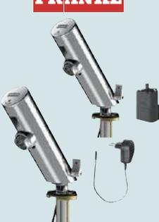
■ Mitigeur Electronique sur plan avec pile lithium 6v ■ Raccordement sur l'arrivée d'eau froide et d'eau chaude ■ Raccordement avec clapets anti retour intégrés et filtres ■ Levier de sélection de température et butée de température réglable. ■ Rinçage hygiénique activé 24h après la dernière activation ■ Coupure de sécurité en cas de réflexion permanente ■ Compartiment à pile Lithium pour montage en dessous du lavabo
