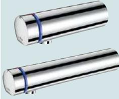
■ Longueur 110 mm ■ Réglage de la température et déclenchement sur le croisillon ■ Temporisation ~7 secondes, débit pré-réglé à 3 l/min à 3 bar, ajustable de 1,5 à 6 l/min ■ Brise-jet antitartre inviolable ■ Fixation murale M1/2" ■ Arrivées d'eau encastrées ■ Filtres et clapets anti-retour ■ Butée de température réglable ■ Garantie 10 ans
