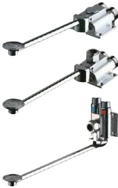
■ Robinet ou mitigeur instantané de lavabo à commande au pied ■ Fermeture automatique instantanée ■ Pédale rabattable pour faciliter le nettoyage du sol, hauteur de pédale réglable ■ Fixation par 4 vis ■ Alimentation en eau froide ou eau mitigée ■ Montage au sol ou mural M1/2" ■ Garantie 10 ans
